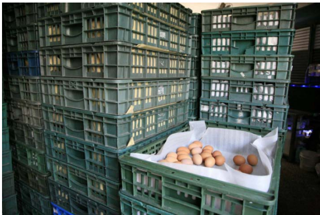
與物流箱內壁密合的一次性內襯以不易破損之材質作為區隔
