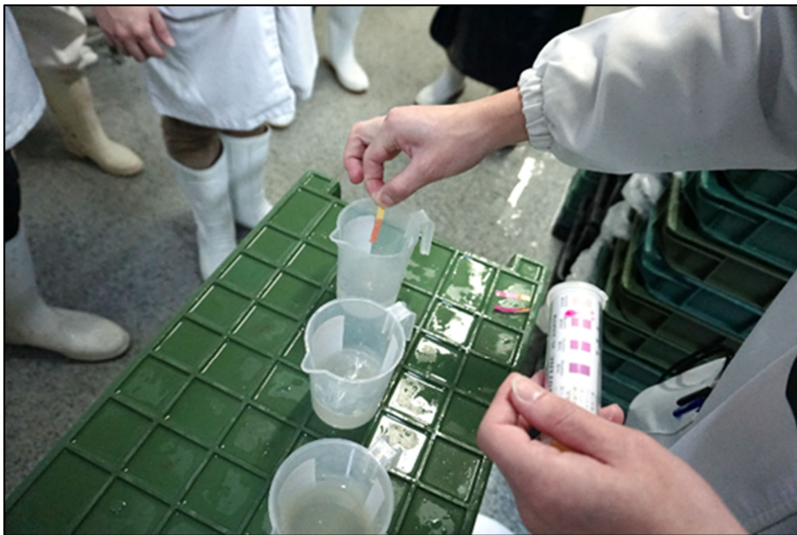
圖四、屠宰作業中需定時檢測並記錄槽內含氯消毒劑餘氯濃度。
