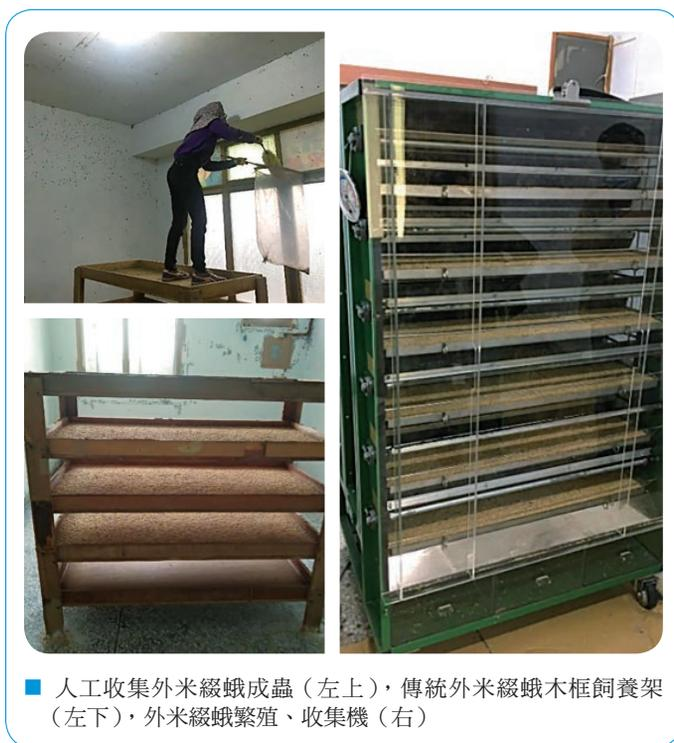
■ 人工收集外米綴蛾成蟲（左上），傳統外米綴蛾木框飼養架（左下），外米綴蛾繁殖、收集機（右）
