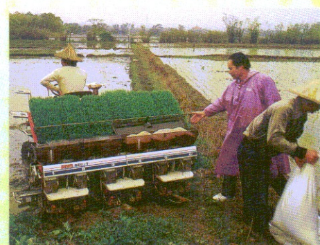
藥劑混合肥料以插秧機附掛深層施肥機施藥情形
